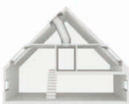
Tagsüber spart man Kunstlicht: der Lichteinfall wird über ein Rohr in den Raum darunter geleitet. Ergänzend ist ein LED Beleuchtungszusatz für die Abendstunden verfügbar.
