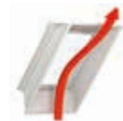
Die Laibungsteile über und unter dem Fenster schaffen mehr Platz für Wärmedämmung am Übergang zwischen Dachfenster und Dach.
