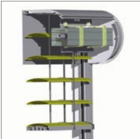
Eine spezielle Umlenkmechanik der Textbänder (Aufzugsbänder) im Kasteninneren, ermöglicht eine optimale Nutzung des verfügbaren Kastenvolumens und gewährleistet sehr geringe Lamellen-Pakethöhen bei entsprechenden Anlagenhöhen. Das gesamte Lamellenpaket inklusive Unterleiste findet bei hochgefahrenem Lamellenbehang im Kasten Platz.
