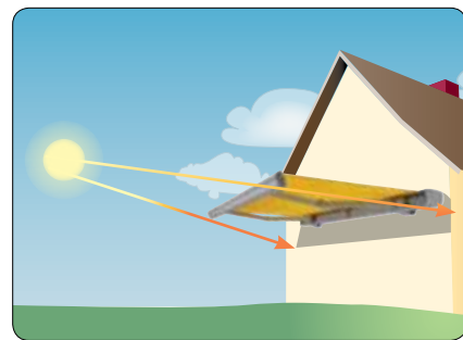
Tiefstehende Sonne z.B.: Westfassade
