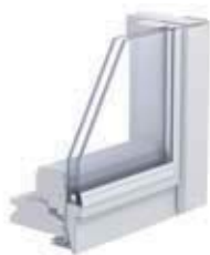
Flüster-Verglasung erhöht den Lärmschutz besonders bei Regen
