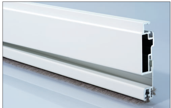
Der im Profil integrierte Multifunktionskanal nimmt die Bürstendichtungen, den schallhemmenden Magnetbandverschluss und die justierbaren 2-Punkt-Scharniere auf.
