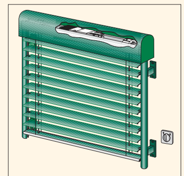
Ausführung freitragend mit stabilen Seitenführungsschienen (ø 42 mm) und Wandträgern inklusive oben abgerundeter Blende.
